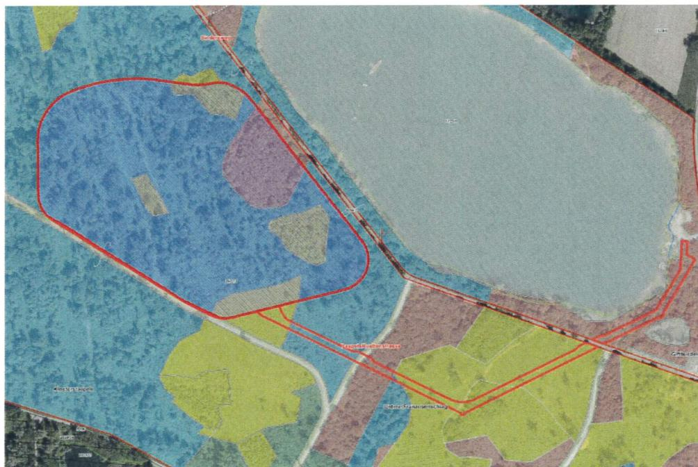
Das neue Projekt hat nur noch eine Größe von ca. 3ha Abbaufäche in Nassbaggerung. Diese massive Verkleinerung ist nun damit begründet, dass die offene Wasserfläche bis zu 3 ha keine Erwärmung des Grundwassers herbeiführen soll und andererseits so weit von Meiningen abrückt, dass auch keine negativen Einflüsse auf die Brunnen von Meiningen zu erwarten sind.
